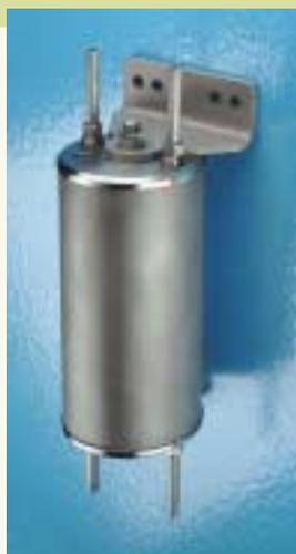
Легкий теплообменник для высокого давления, разработанный в полном соответствии требованиям стандарта API 682. Способен обеспечить выпуск и слив как продукта, так и хладагента. Легко демонтируется для очистки без повреждения змеевиков. Стандартные материалы: змеевик марки 300 и кожух.
