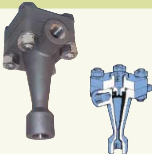
Выпускаемые в виде шести разных модификаций данные сепараторы предназначены для эффективного удаления песка, трубной накипи и других абразивных частиц из потока, поступающего к механическим уплотнениям. Отделение частиц достигается за счет действия центробежной силы, сформированной перепадом давлений на циклоне.
