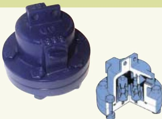
Магнитный сепаратор предназначен для входного потока механического уплотнения (план 23), а также установки в контрольных трубопроводах и других местах. Создает магнитное поле, которое отделяет и удерживает частицы окиси железа из технологической жидкости, исключая возможность абразивного воздействия или зависания.
