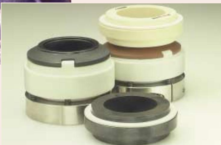
**Н**аружные уплотнения применяются в приложениях с участием активно-коррозионных агентов. Данный режим работы предусматривает такие конструкции уплотнений, которые не имеют металлических деталей, контактирующих с технологической жидкостью. Разработаны модификации с пружинными уплотнениями
