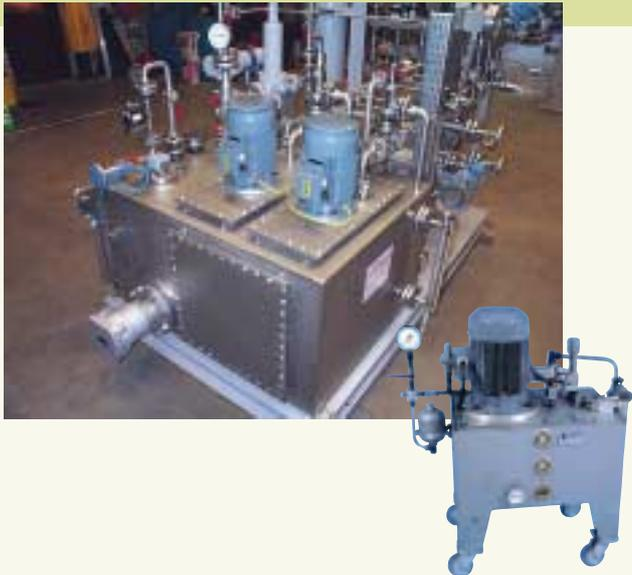
Замкнутые контуры часто герметизируются с помощью стационарных систем герметизации, которые, как правило, построены на основе относительно небольшого изолирующего резервуара с одним или несколькими насосами с электродвигателем.
