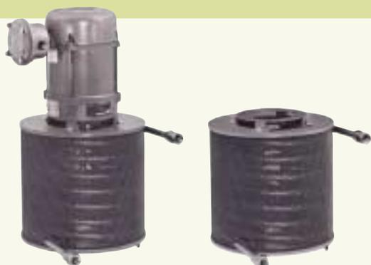
Теплообменники с воздушным охлаждением обеспечивают понижение температуры вокруг механического уплотнения без использования охлаждающей жидкости. Этим достигается существенная экономия затрат на проточную воду и ее очистку, а данные устройства менее чувствительны к загрязнению и требуют меньшего количества трубных соединений.
